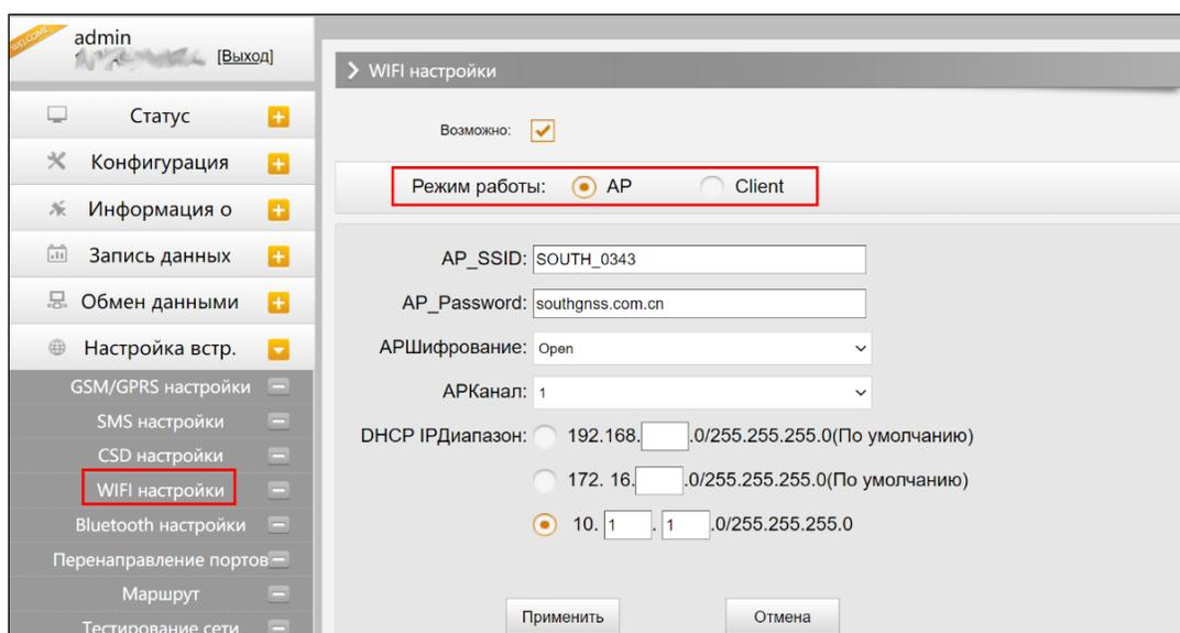
Режим точки доступа (AP): приемник создаст точку доступа WIFI, подключившись к которой, компьютер или мобильный телефон может открыть Web-интерфейс приемника.
