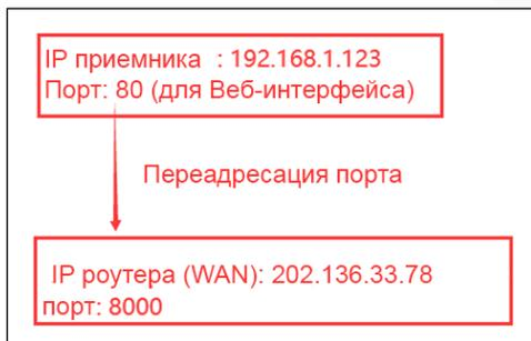
После настройки переадресации портов компьютер или мобильный телефон может получить доступ к Веб-интерфейсу приемника, как показано на изображении ниже.
