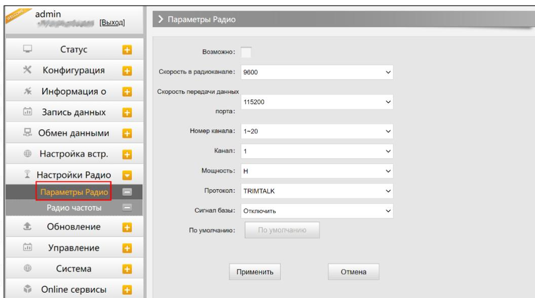
Скорость в радиоканале: Скорость передачи данных по воздуху в режиме встроенного радио. Чем выше скорость передачи данных, тем больше данных передается в секунду. По умолчанию установлено значение 9600.
