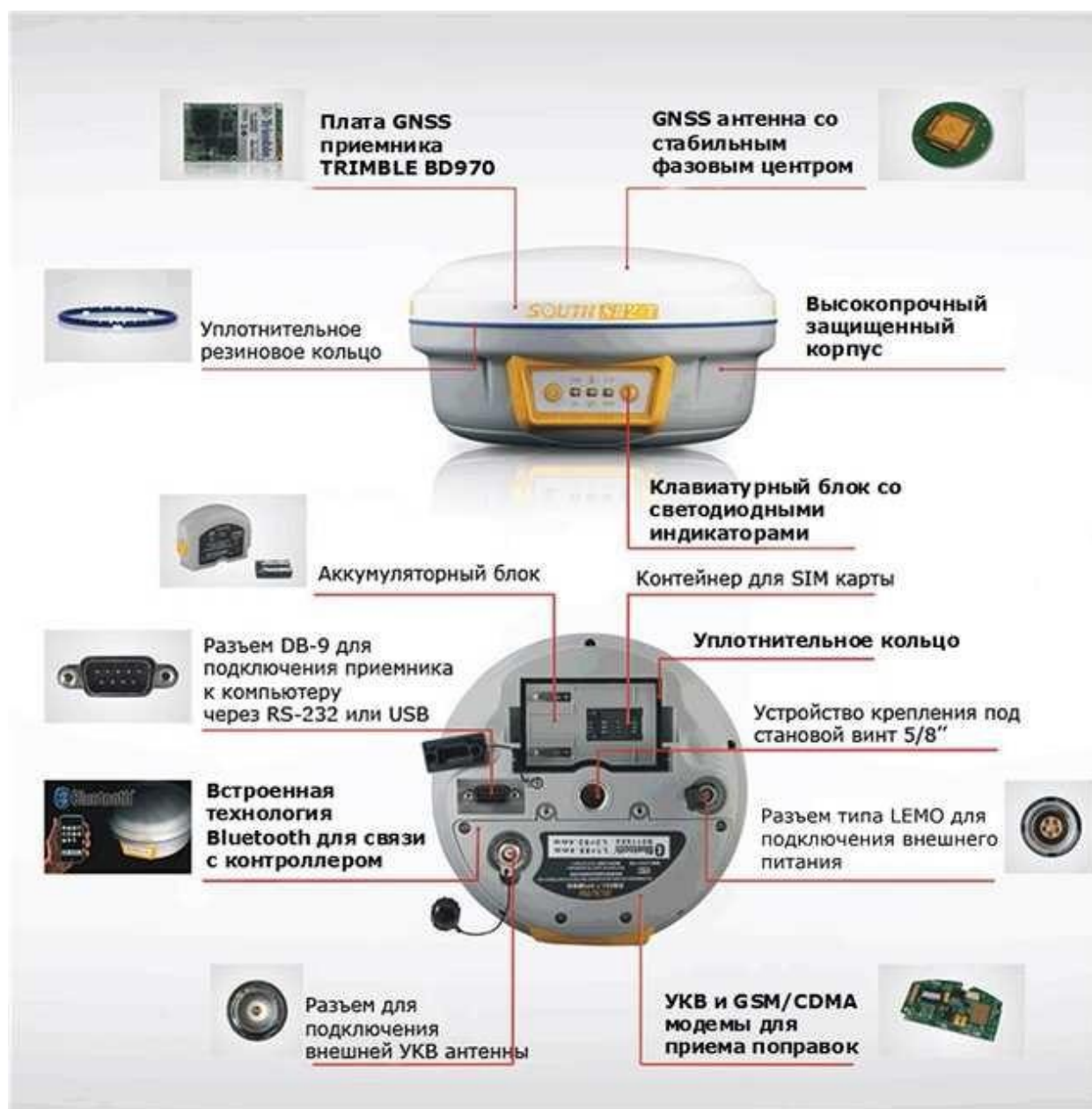
Рисунок 2.1 Общий вид и компоновка составляющих S82T
