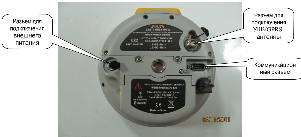
Рисунок 2.3 – Порты связи основного блока S82T
