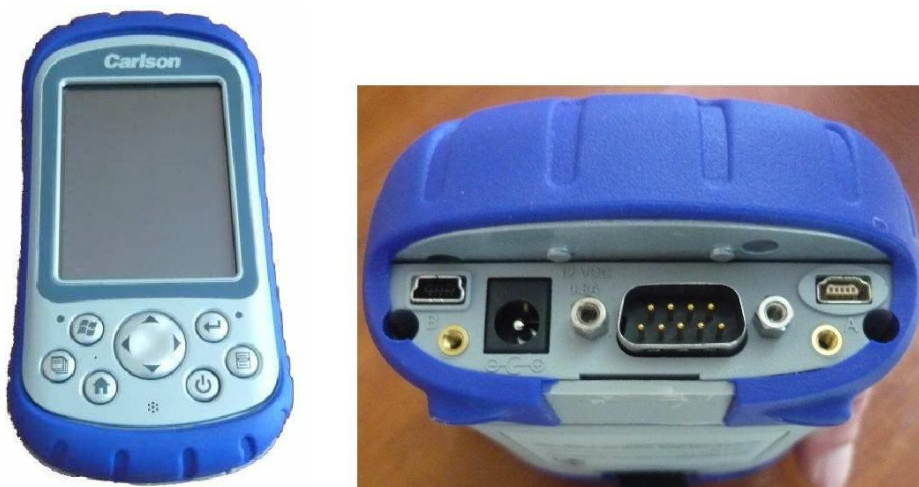
Рисунок 4.1. Внешний вид контроллера Carlson MINI
