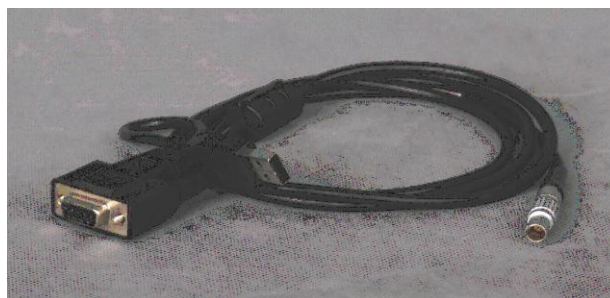
Рисунок 1.3 – Кабель для соединения GNSS – приемника и компьютера
