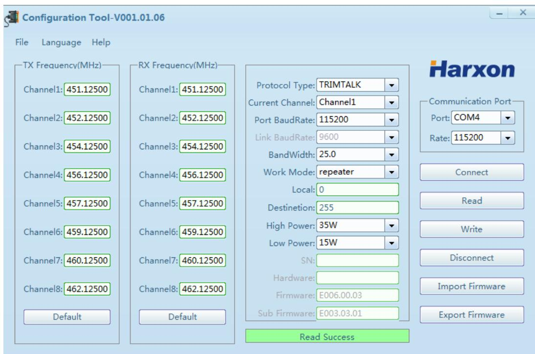
TX frequency – частоты, на которых радиомодем будет передавать данные, RX frequency – принимать. Для сохранения настроек нажмите «Write». Для выхода из режима настройки нажмите «Disconnect».
