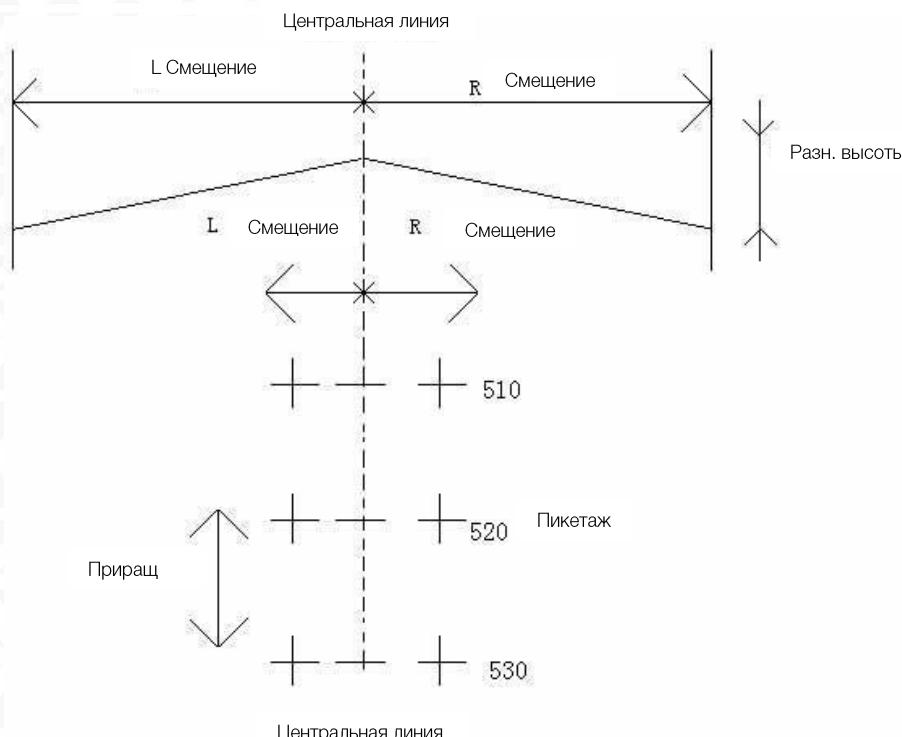
При разбивке трассы, пользователь должен сначала вынести точки на центральной линии, а затем точки по краям трассы.
