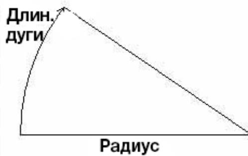
Чтобы создать дугу, выберите в меню "Тип гор. сегмента" (Hz Alignment type) опцию "Дуга" (ARC). Она состоит из длины дуги и радиуса. Радиус задается в направлении движения по дуге. Когда дуга поворачивает направо, значение радиуса положительное, а когда кривая поворачивает налево, значение радиуса отрицательное. Длина дуги не может быть отрицательной.
