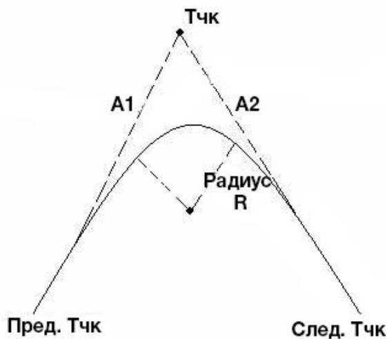
Чтобы создать точку, выберите в меню "Тип гор. сегмента" (Hz Alignment type) опцию "Точка" (POINT). Она состоит из координат, радиуса и коэффициентов кривой A1 и A2. Радиус, A1 и A2 не могут быть отрицательными. При вводе радиуса между текущей и следующей точкой образуется дуга с заданным радиусом. При вводе коэффициентов спирали A1 или A2 между линией и дугой вставляется кривая с заданными коэффициентами.
