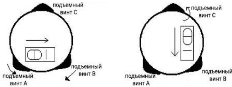
В случае если точка лазерного отвеса сместились с центра необходимой точки, ослабьте становой винт и перемещайте прибор (не поворачивая его) пока точка лазерного отвеса не окажется в центре необходимой точки. Затяните винт и снова выставьте прибор по уровню. Повторяйте эти действия до тех пор, пока прибор не будет выставлен по уровню и отцентрирован на точке.
