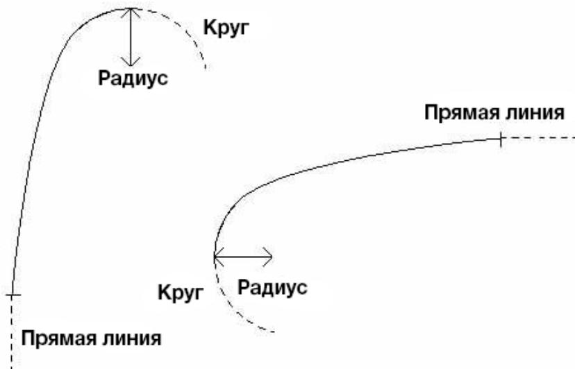
Чтобы создать кривую, выберите в меню "Тип гор. сегмента" (Hz Alignment type) опцию "Кривая" (SPRIAL). Спираль состоит из минимального радиуса и длины дуги. Радиус задается в направлении движения по кривой. Когда кривая поворачивает направо, значение радиуса положительное, а когда кривая поворачивает налево, значение радиуса отрицательное. Длина кривой не может быть отрицательной.
