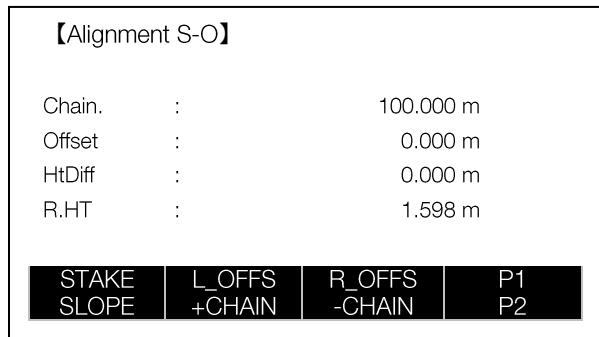
L\_OFFSET: Эта клавиша используется для разбивки левого пикета. Нажмите ее, чтобы отобразить смещение и разницу в высоте.
